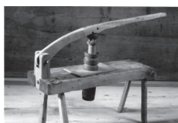
Le cacâ-trifles: levier enfonçant un cylindre dans un creux, serti d'une grille.
